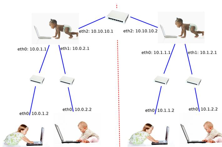
22) Configurez maintenant l'interface *eth2* de *opeth* qui est reliée au switch principal qui permet de faire la jointure entre les sous-réseaux de chaque groupe.
